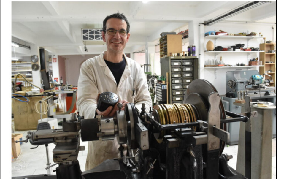
Avec un tour à gullocher, Frédéric Hamel réalise des pièces uniques en retirant de la matière à sa guise, pour créer des formes et des reliefs. ©Vincent GUERRIER
